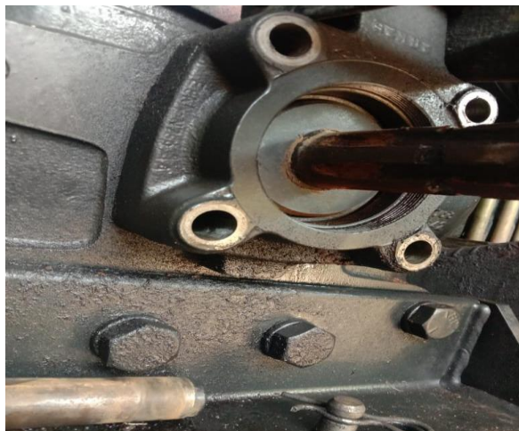
Gambar 9. Kebocoran Pada Seal PTO
