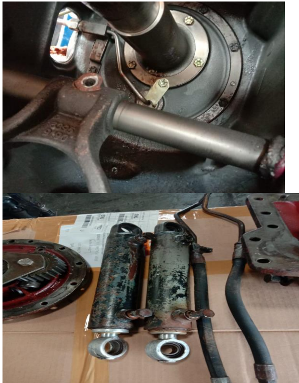
Gambar 5. Kebocoran Pada Seal Input Shaft transmisi dan Pada Seal Cylinder Steering
