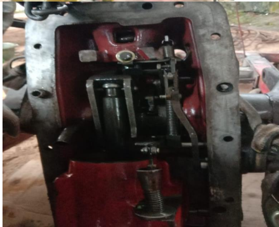
Gambar 6. Kerusakan Pada Clutch Transmisi dan Hydraulic
