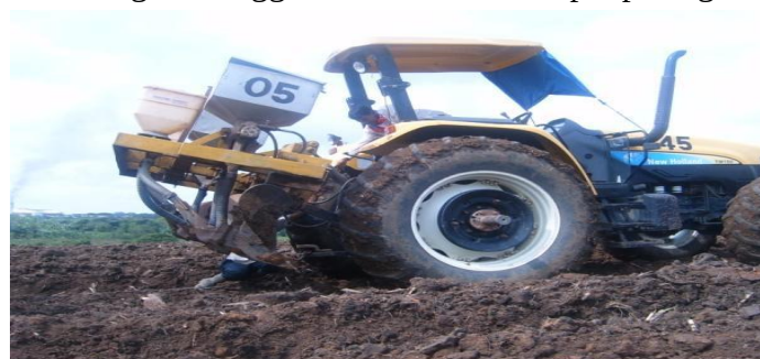
Gambar 3. Pemupukan Menggunakan Implemant Fantilizer Aplikator/Pikon
